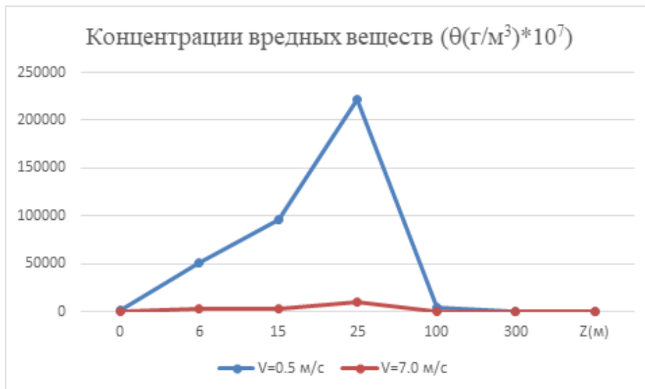
Рис. 1 Концентрация вредных веществ в атмосфере при скорости движения воздушных масс V = 0.5 м/с и V = 7.0 м/с при разных высотах
